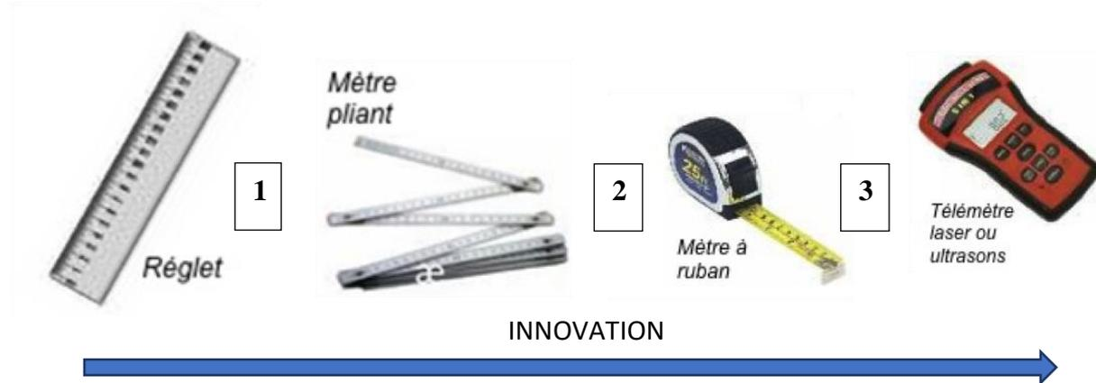
L'exemple ci-dessus met en évidence l'évolution de la mesure de distance au fil du temps, depuis la simple règle jusqu'au télémètre laser ou ultrason. N'hésitez pas à rechercher sur Internet ce qu'est un Télémètre Laser ou ultrason...
